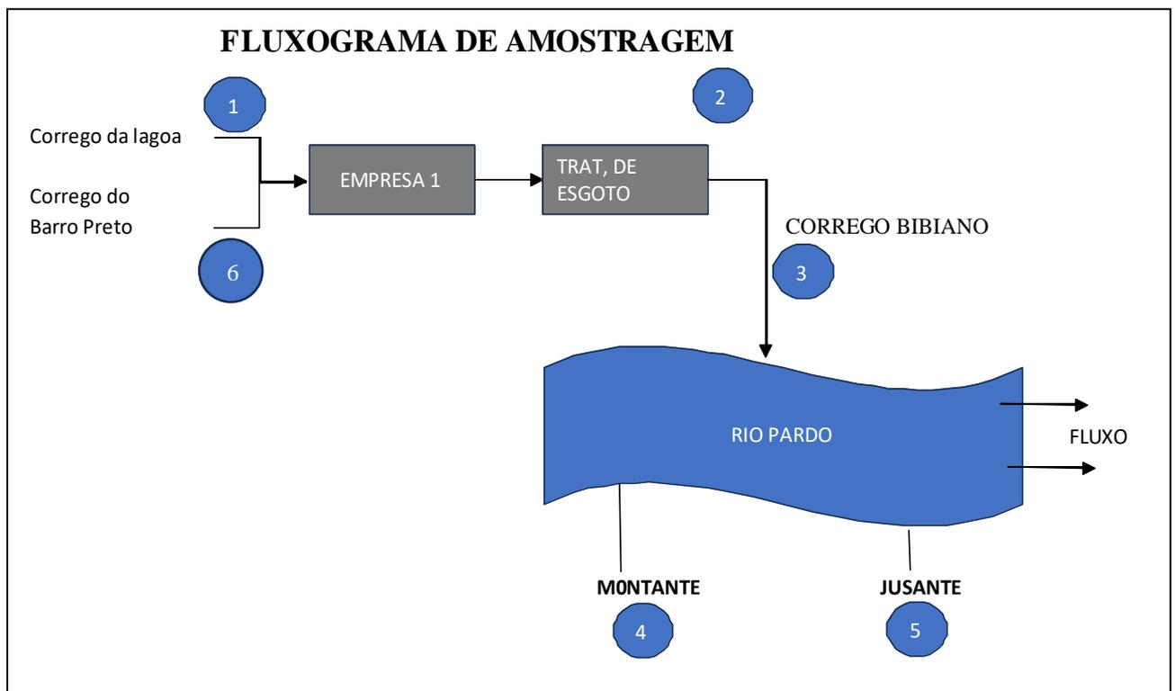
Figura 8: fluxograma de amostragem
