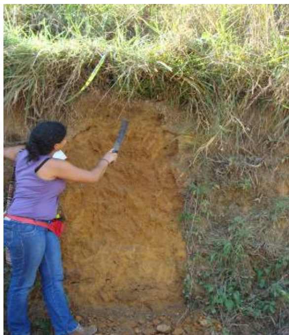
Figura 1: Analisando perfil solo, e coleta de amostra para análise granulométrica, verificar presença no perfil do solo de Btextural; Assentamento Roseli Nunes, 07/2008.
